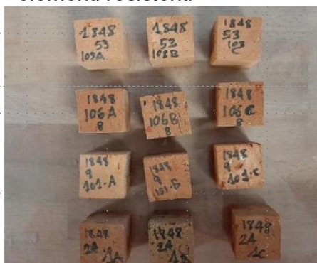
DM5 – Prova di compressione su elementi resistenti
